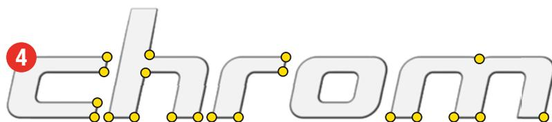
**Rundung der Ecken  $R = 0,25 \text{ mm}$**
